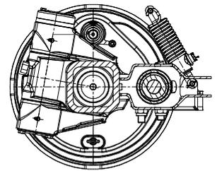
Bielas industriales regulables para ajuste de frenos por el desgaste por uso.
